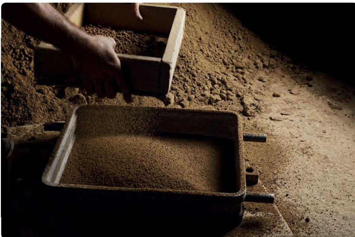
As camadas de terra seguintes já não necessitam de ser crivadas, são calcadas com o calcador de madeira para que a terra fique bem compactada, a última camada de terra é calcada com um calcador de ferro com base larga, para se conseguir uma maior consistência.
