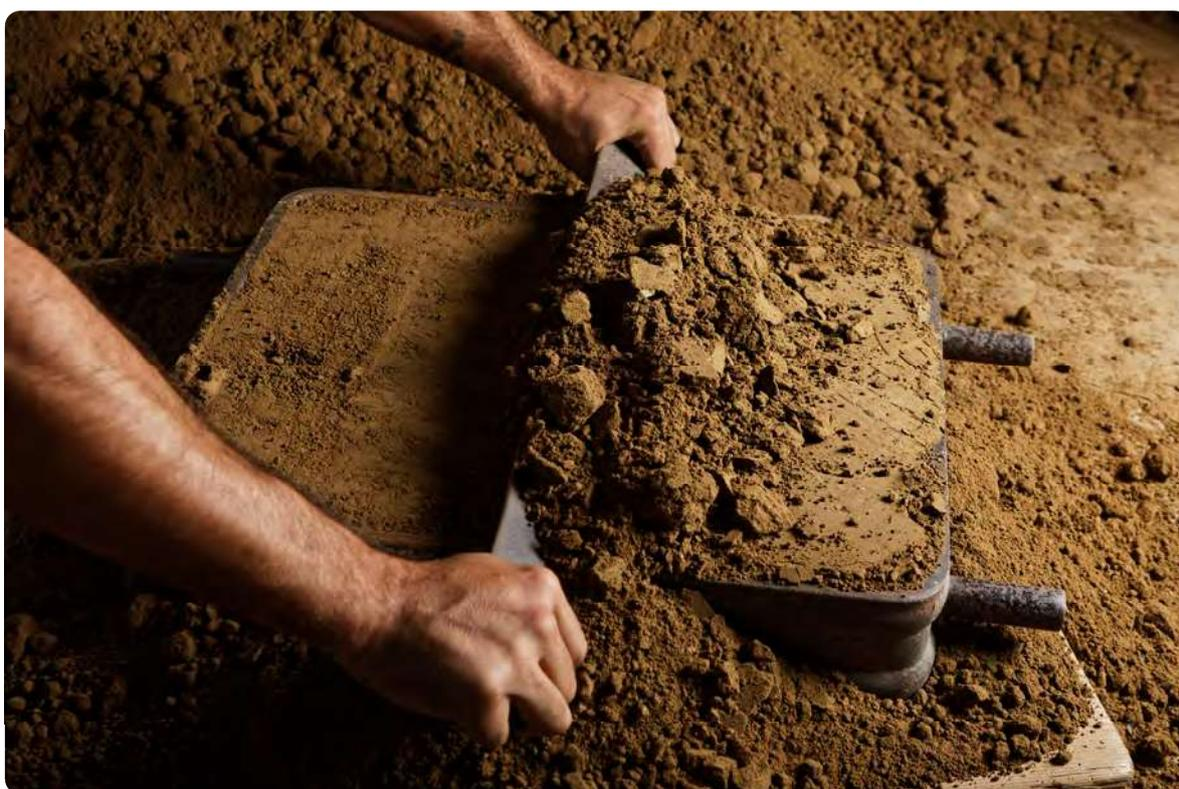
Abre-se a caixa e faz-se a apartação da peça, ou seja, com uma pequena pá ou lancete, conforme a peça, retiram-se os excessos de terra em volta do molde.
