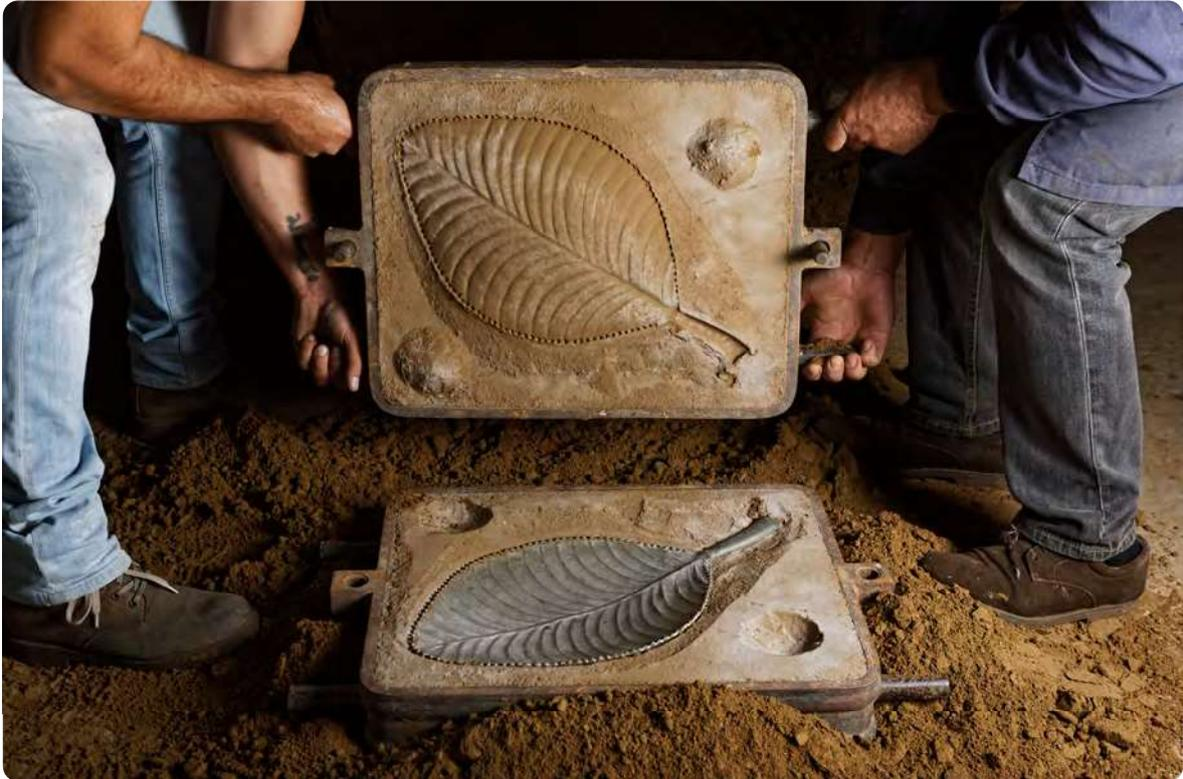
Com um martelo de borracha, bate-se levemente para pressionar a terra/areia de fundição para criar mais espaço entre moldes.
